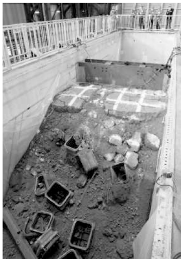
評価実験では鋼製土槽の中に水道管を埋設し、最大変位20cmの震動を与えた
