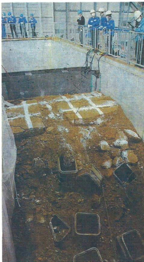
地盤崩壊を再現し、地中の水道管のつなぎ目の強度を確かめた三木市志染町
